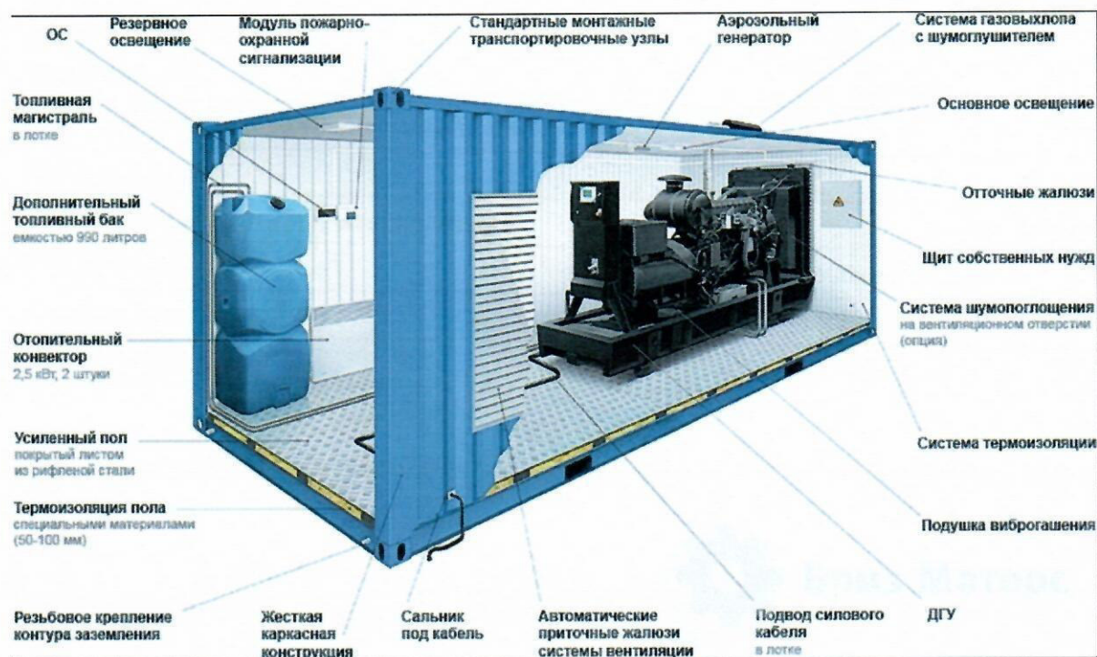
Рисунок 6 Схема ДГУ СТМ М.1900 в контейнерном исполнении
