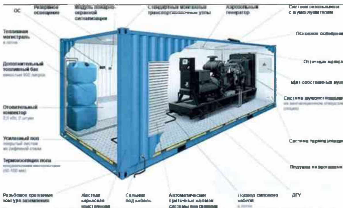
Рисунок 6 Схема ДГУ СТМ М.1900 в контейнерном исполнении
